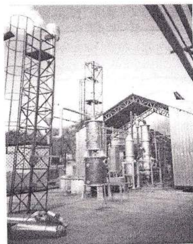
Figura 11.30 — Planta-piloto da UNICAMP para testes de pirólise rápida (Olivares Gómez, 2002; Mesa-Pérez, 2003)
